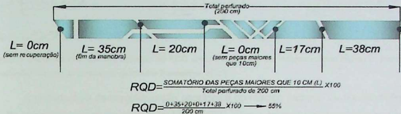
Figura 5: Esquema com o procedimento para o cálculo de RQD
